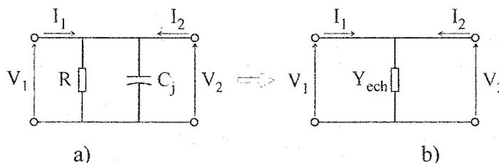
Figure 2.3. a) Circuit K. Yamauchi; b) Circuit équivalent
