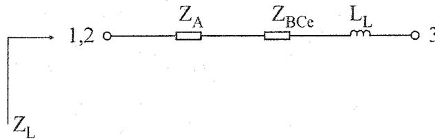
Figure 3.21. Circuit équivalent V pour le modèle HSMS-2822
