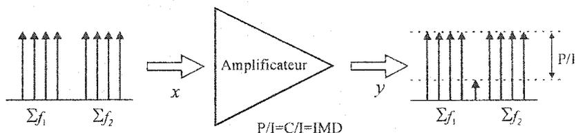
Figure 1.9. Méthode de mesure par multi-porteuses
