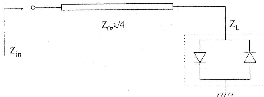
*Figure 3.14. Paire transformée de la diode Schottky*
