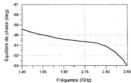
**Figure 2.34.** Équilibre de phase du coupleur hybride 90 degrés
