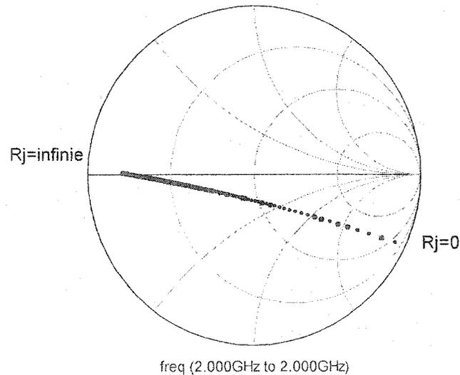
**Figure 3.22.** Le contour de l'impédance du modèle à deux diodes en série avec un transformateur d'impédance en fonction de la résistance de jonction
