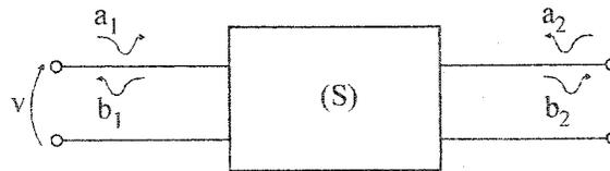
Figure 3.25. Réseau avec deux ports
