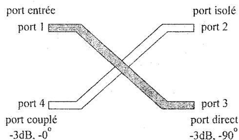
**Figure 2.30.** Principe du coupleur hybride 90 degrés
