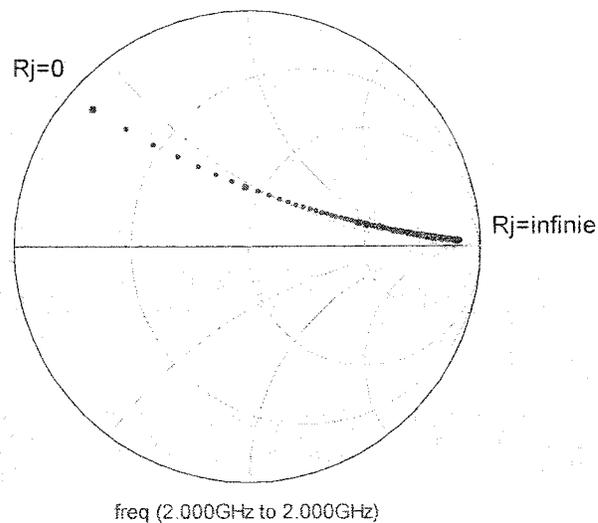
**Figure 3.12.** Le contour de l'impédance du modèle en parallèle avec une inductance d'accord en fonction de la résistance de jonction
