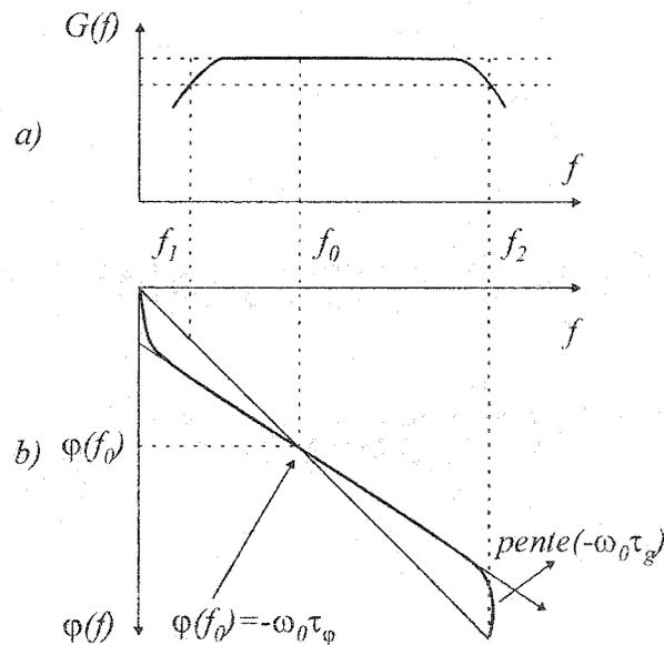
**Figure 1.4.** Distorsions linéaires: a) de gain, b) de phase
