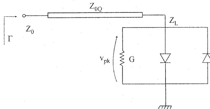
**Figure 3.28.** Circuit d'analyse pour le circuit de prédistorsion
