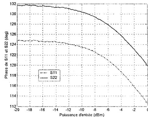
**Figure 3.49.** Variation de la phase des coefficients  $S_{11}$  et  $S_{22}$  avec la puissance d'entrée
