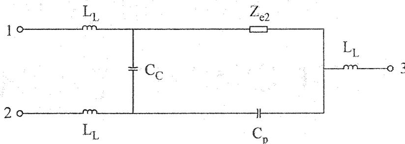
Figure 3.7. Circuit équivalent III pour le modèle HSMS-2820
