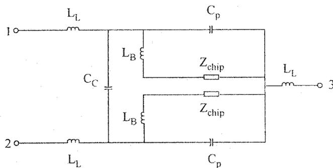
Figure 3.16. Circuit équivalent I pour le modèle HSMS-2822
