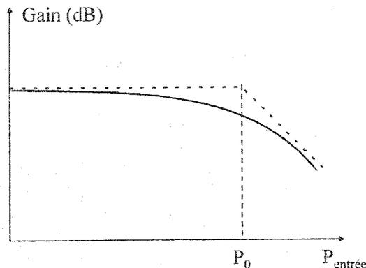
*Figure 1.3. Courbe de gain d'un amplificateur de puissance*
