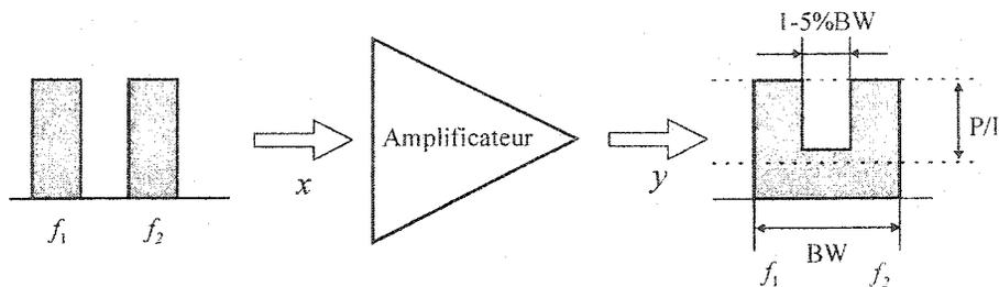
Figure 1.10. Méthode de mesure par source de bruit
