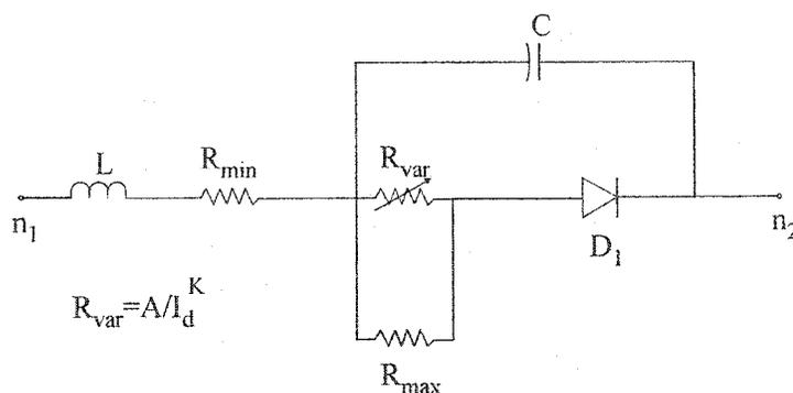
*Figure 2.29.* Le modèle APLAC de la diode PIN
