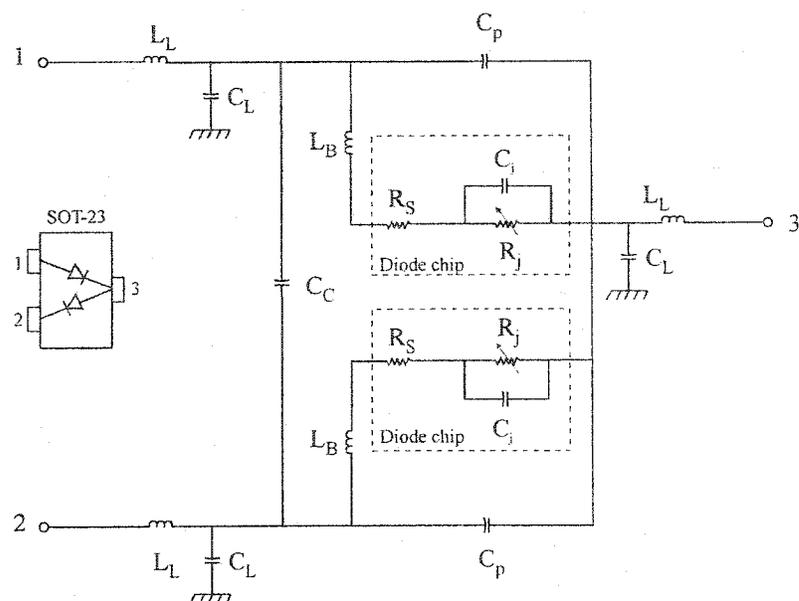
Figure 3.15. Modèle de la diode Schottky HSMS-2822
