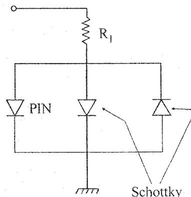
Figure 3.24. Topologie avec la diode PIN en parallèle
