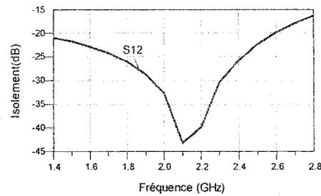
**Figure 2.32.** Isolation du coupleur hybride 90 degrés
