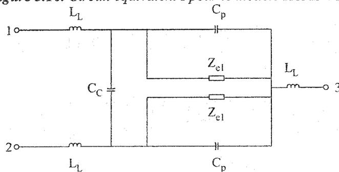
Figure 3.17. Circuit équivalent II pour le modèle HSMS-2822
