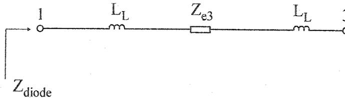
Figure 3.9. Circuit équivalent V pour le modèle HSMS-2820
