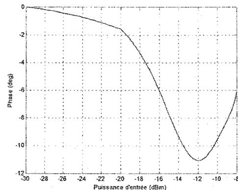
*Figure 3.55. Résultat de la linéarisation de la caractéristique de phase pour le circuit mesuré*
