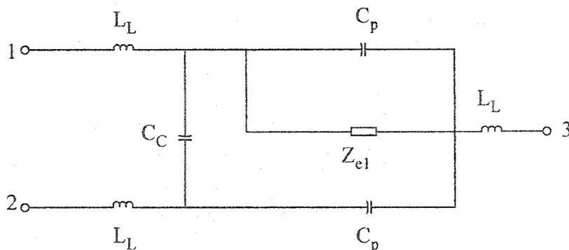
Figure 3.6. Circuit équivalent II pour le modèle HSMS-2820
