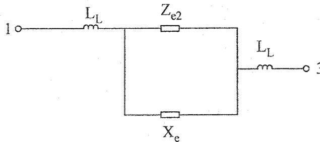
Figure 3.8. Circuit équivalent IV pour le modèle HSMS-2820
