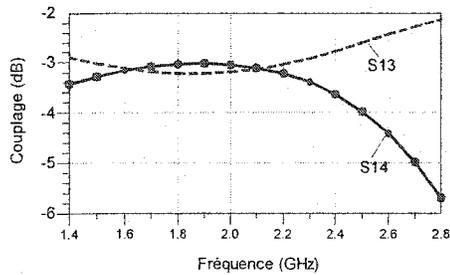
**Figure 2.31.** Couplage du coupleur hybride 90 degrés
