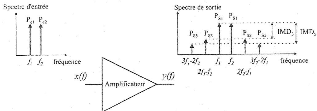
Figure 1.7. Distorsion d'intermodulation
