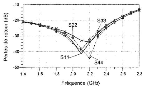
**Figure 2.33.** Pertes de retour du coupleur hybride 90 degrés
