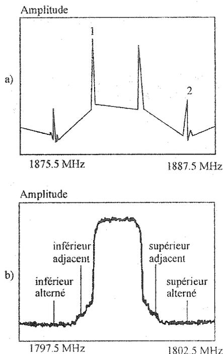
*Figure 1.11. Exemple de mesure d'IMD et d'ACPR*
