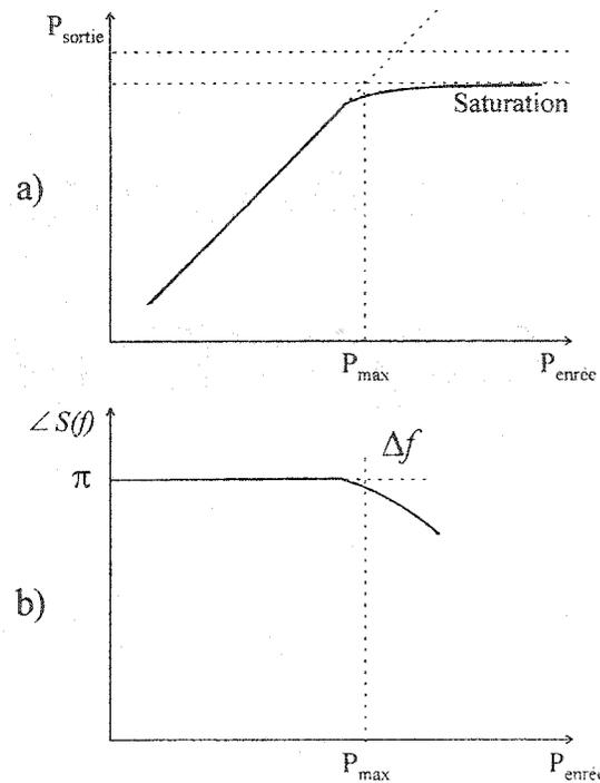
Figure 1.5. Distorsions non-linéaires: a) d'amplitude, b) de phase
