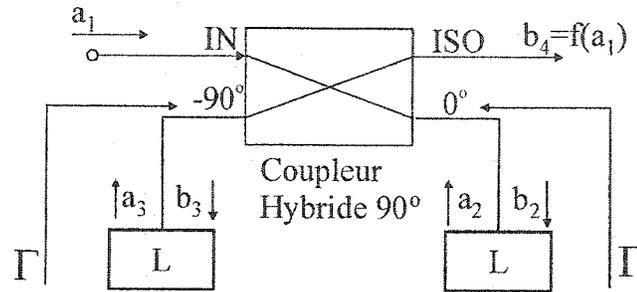
Figure 2.16. Principe du circuit de linéarisation à trois diodes en parallèle
