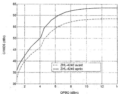
**Figure 4.7.** Caractéristiques des rapports  $C/IMD_5$  vs. *OPBO* de l'amplificateur ZHL-4240 avant et après linéarisation ( $f=2.0$  GHz)
