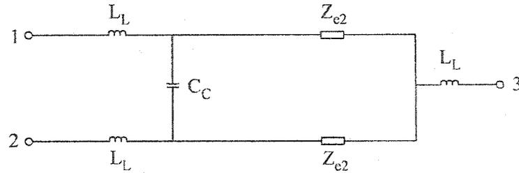
Figure 3.18. Circuit équivalent III pour le modèle HSMS-2822
