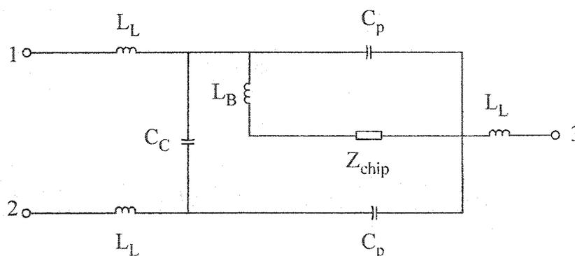
*Figure 3.5. Circuit équivalent I pour le modèle HSMS-2820*
