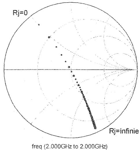
*Figure 3.10. Le contour de l'impédance du modèle en fonction de la variation de la résistance de jonction*
