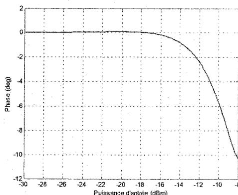
*Figure 2.20. Caractéristique de phase de l'amplificateur à linéariser*
