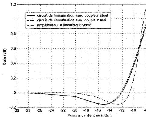
*Figure 3.34. Superposition des caractéristiques de gain du circuit de linéarisation dans les deux versions théoriques et l'inverse de celle de l'amplificateur à linéariser*
