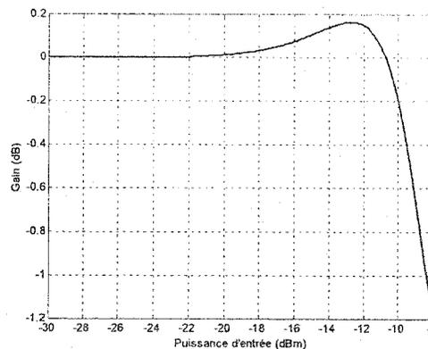
*Figure 2.19. Caractéristique de gain de l'amplificateur à linéariser*
