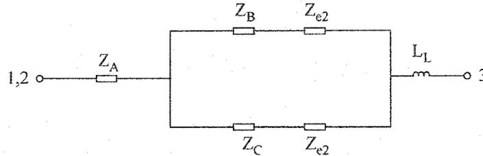
Figure 3.20. Circuit équivalent IV pour le modèle HSMS-2822
