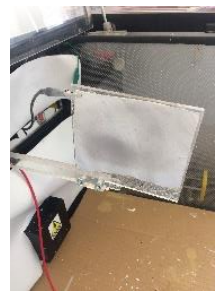
Figura 1. Colector plano recubierto con papel de aluminio y membrana de PS@Fe 3 O 4 electrohilada.
