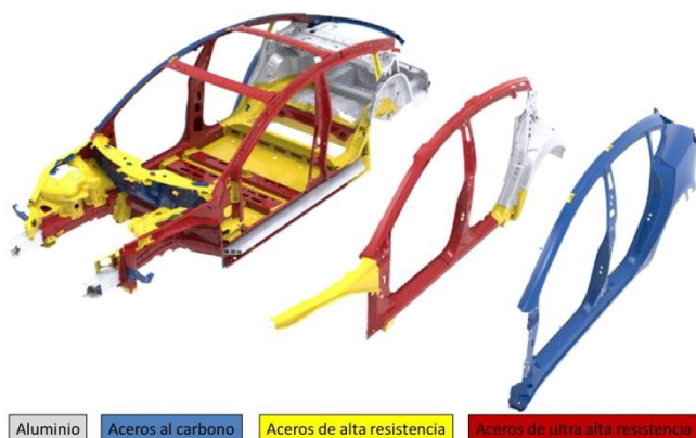
Figura 1. Diagrama de materiales que componen la carrocería del Tesla Model 3 (Tesla Motors Inc., 2018).
