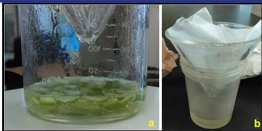
**Figura 1.** a) Cáscaras de limón en agua en ebullición, b) filtración del extracto de limón en un recipiente estéril.
