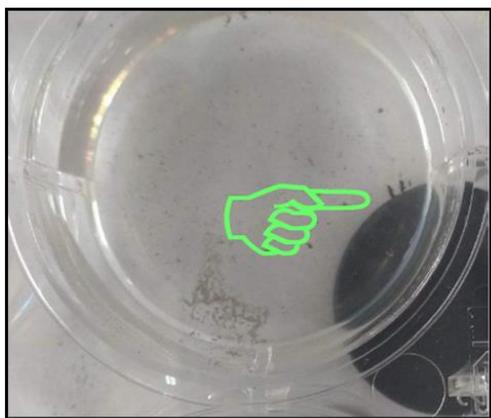
**Figura 10.** Se observa como las  $\text{MPsFe}_3\text{O}_4\text{@Ag}$  son atraídas por el campo magnético del imán.
