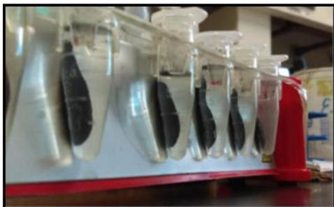
**Figura 3.**  $MPsFe_3O_4$  contenidas en tubos Epp en un separador magnético
