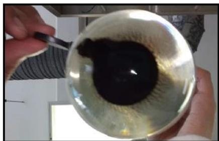
**Figura 2.** Precipitado reaccionando al campo magnético del imán.
