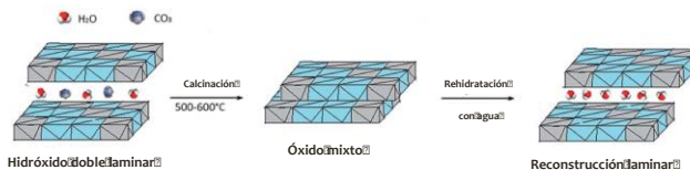
Figura 9. Representación del LDH, el óxido mixto y la reconstrucción del LDH, (González-Olvera et al., 2016).
