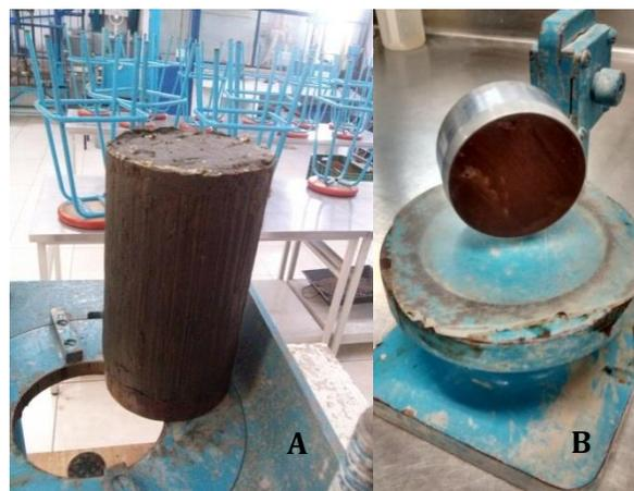
**Figura 6.** A. Extracción de la muestra del tubo Shelby, B. Labrado de la muestra dentro del anillo para el ensayo de consolidación unidimensional.
