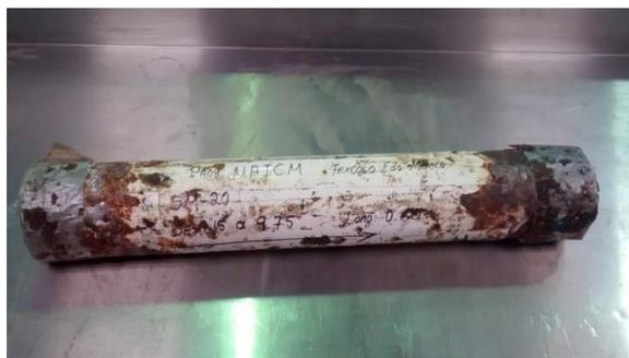
**Figura 5.** Tubo Shelby de donde se extrajo la muestra a ensayar.
