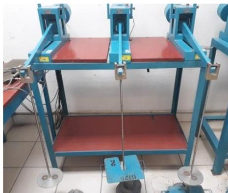
**Figura 10.** Portapesas donde se colocan los incrementos de carga aplicados a la muestra a ensayar.
