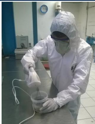
**Figura 7.** Equipo de seguridad utilizado para elaborar las mezclas con nano-silíce.
