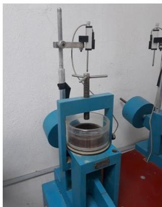
**Figura 9.** Marco de carga para el ensayo de consolidación unidimensional.
