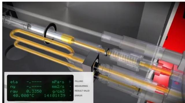
Figura 3. Vista 3D, de celdas de densidad y viscosidad (viscosímetro SVM 3000).
