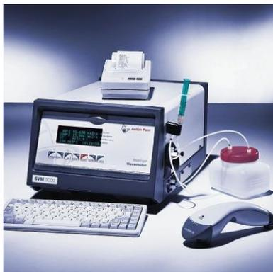
Figura 1.. Viscosímetro SVM 3000 STABINGER.
