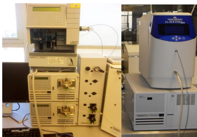
Figura 2. Equipo HPLC Varian con detector de UV-Vis y detector IR.
