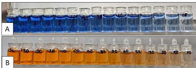
**Figura 1.** Se observa la intensidad en las soluciones para los colorantes A. AR19, B. NR84, utilizados para la curva de calibración.
