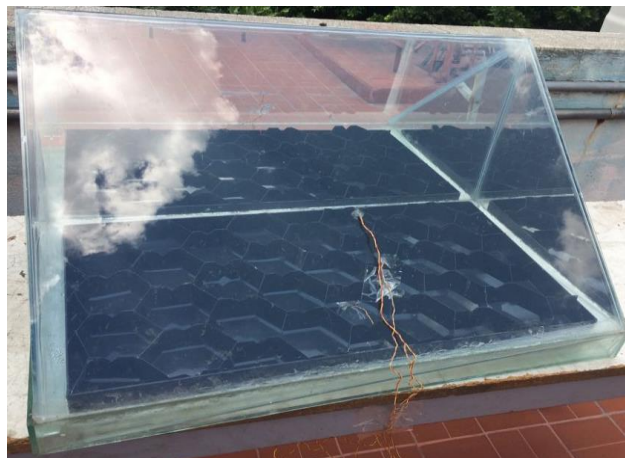
Figura 1. Destilador solar tipo caseta con aletas y reflectores internos.
