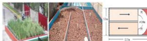
Figura 1. Humedal de Flujo sub-superficial con detalle de la curvatura en cambio de canal y vista real de la curva (Osornio, 2017b y Osornio et al., 2017a).
