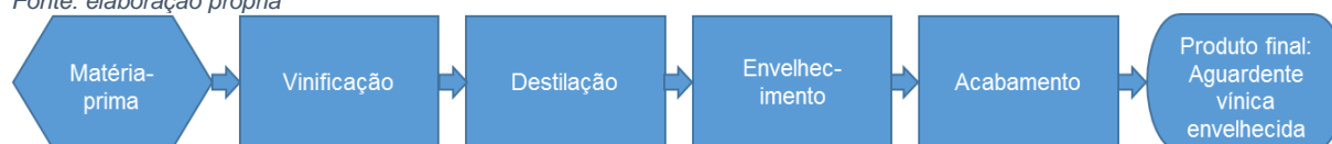
Figura 2-1. Diagrama do processo produtivo de aguardentes vínicas envelhecidas: sub-processos. Fonte: elaboração própria
