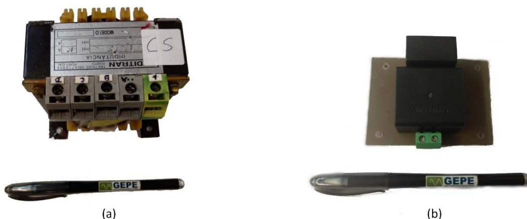
Figura 5.25 – Componentes para os filtros passivos dos conversores: (a) bobine com núcleo de ferro; (b) condensadores do tipo polipropileno.
