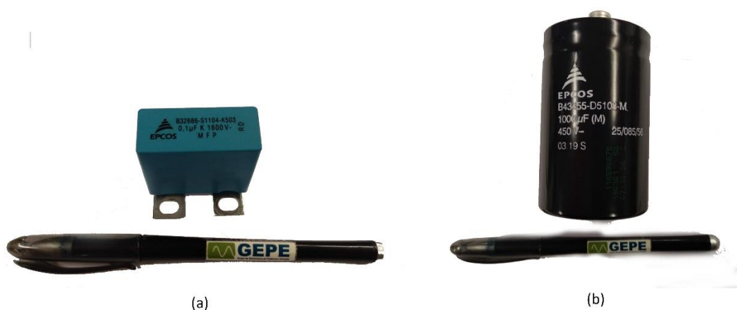
Figura 5.22 - Condensadores usados no barramento CC: (a) condensador de Snubber ; (b) condensador eletrolítico.
