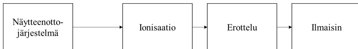
Kuva 1. Ioniliikkuvuusspektrometrien lohkokaavio. Kaasut tuodaan näytteenottojärjestelmästä ionisaattorille, jossa ne ionisoituvat. Erottelu tapahtuu sähkökentän avulla. Lopuksi ionit kulkeutuvat ilmaisimelle.
