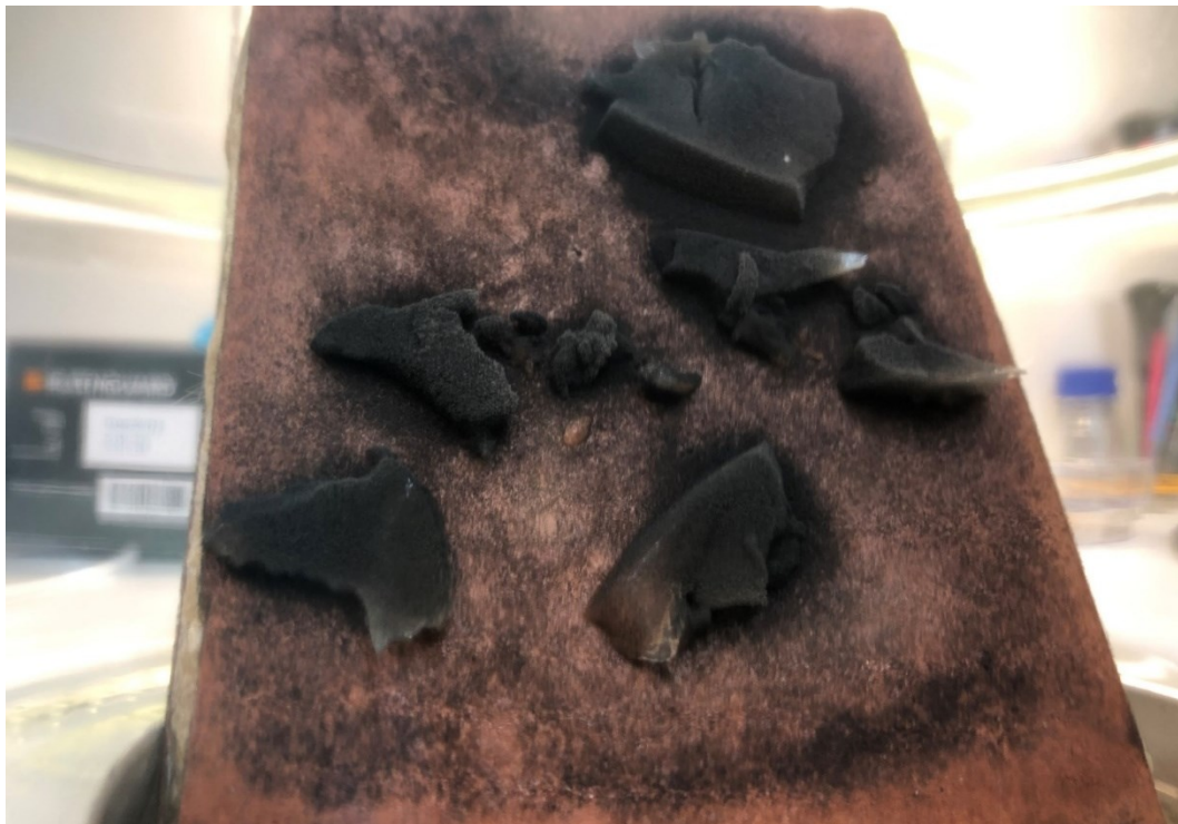
Kuva 11. Home ja agar kipsilevyllä kasvatuksen lopussa, 17.5.2021. Home on levinnyt lähes kauttaaltaan kipsilevyn pinnalle.
