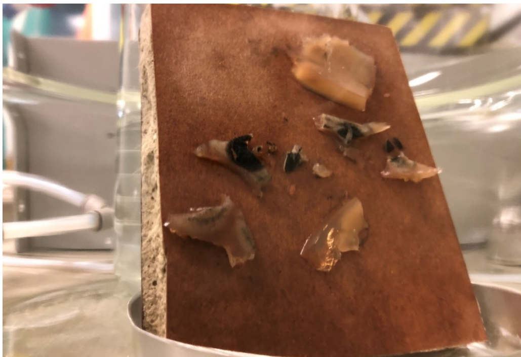
Kuva 9. Home ja agar 10 cm halkaisijaltaan olevalla kipsilevyllä kasvatuksen alussa, 31.3.2021. Home näkyy tummina pisteinä hyytelömäisen agarin pinnalla.
