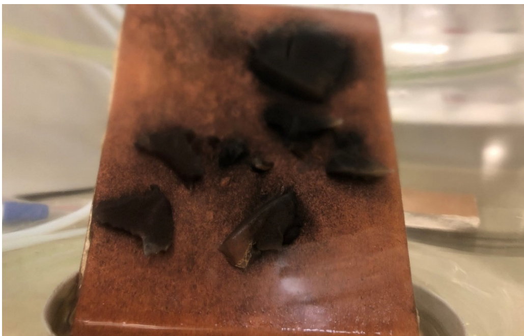
Kuva 10. Home ja agar olevalla kipsilevyllä kasvatuksen puolessa välissä, 15.4.2021. Home on levinnyt kipsilevyn pinnalle ja peittää lähes kokonaan agarin pinnan.
