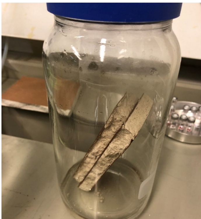
Kuva 12. Referenssikipsilevyt suljettuna 30 cm korkeaan säiliöön, jonka pohjalla on steriiliä vettä.
