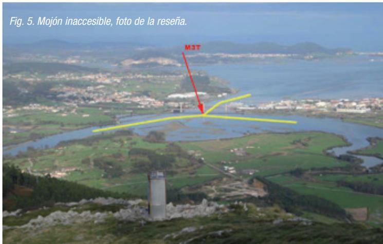
que aparece en la reseña, será una foto del entorno del punto, en la que se haga una marca con la ubicación aproximada del mojón, las coordenadas se determinarán de forma gráfica en la cartografía o la ortofoto y se dan redondeadas al m.
