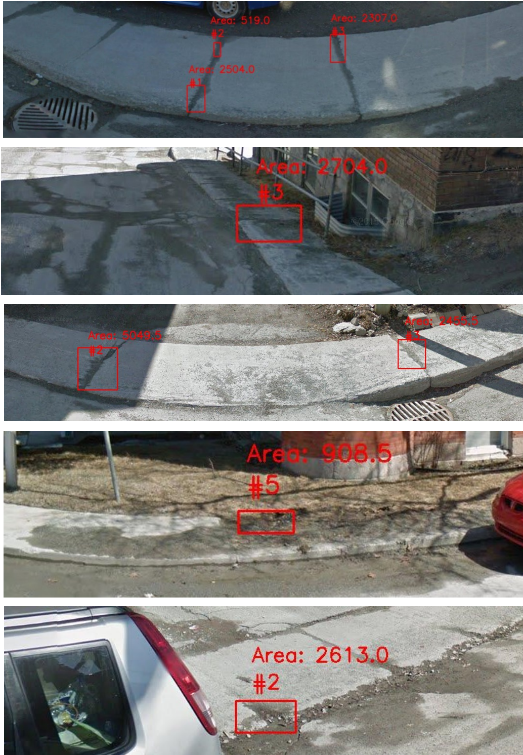
Figure 41 : Exemples de faux positifs liés à la sous-représentation d'images captées au printemps et à l'automne. Chaque défaut est entouré d'une boîte, d'un chiffre unique identifiant ce défaut sur l'image de référence, ainsi que de l'aire, en pixel, du défaut. Ces exemples sont issus de la chaîne de traitement finale (après post-traitement).
