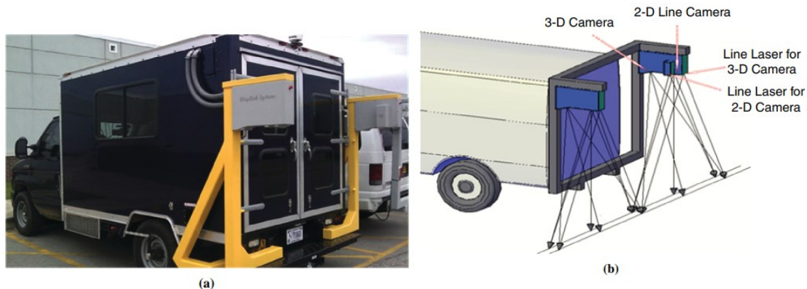
Figure 49: Système PaveVision3D avec résolution de 1 mm . a) extérieur et (b) fonctionnement (tire de Luo et al. , 2014, p.122)
