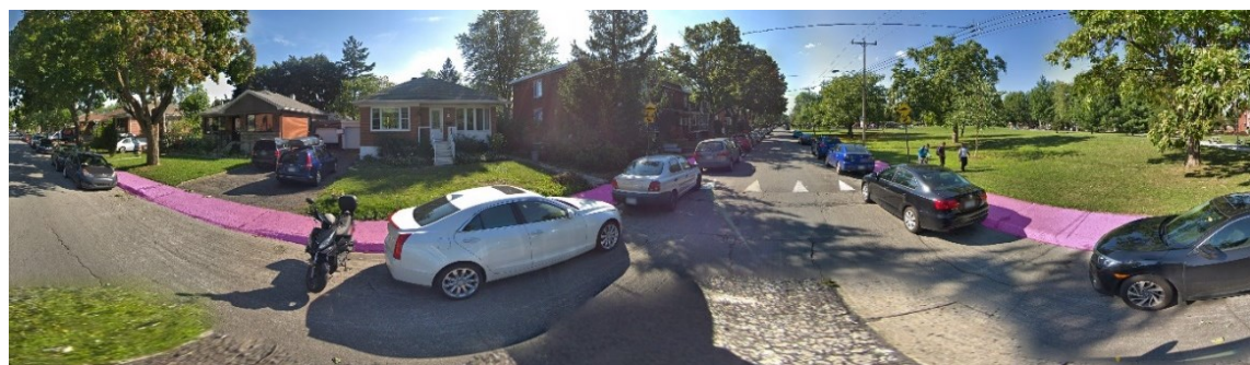
Figure 33: Superposition d'un panorama Google Street View et d'un masque de segmentation (en rose) pour les pixels de la classe «Trottoir». Ce masque a été produit par le modèle Deeplabv3+ entraîné sur les données d'entraînement du présent projet.
