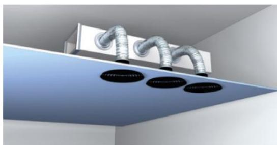
Figura 52 - Ligação de conduta flexível a unidades terminais, Fonte: [6]
