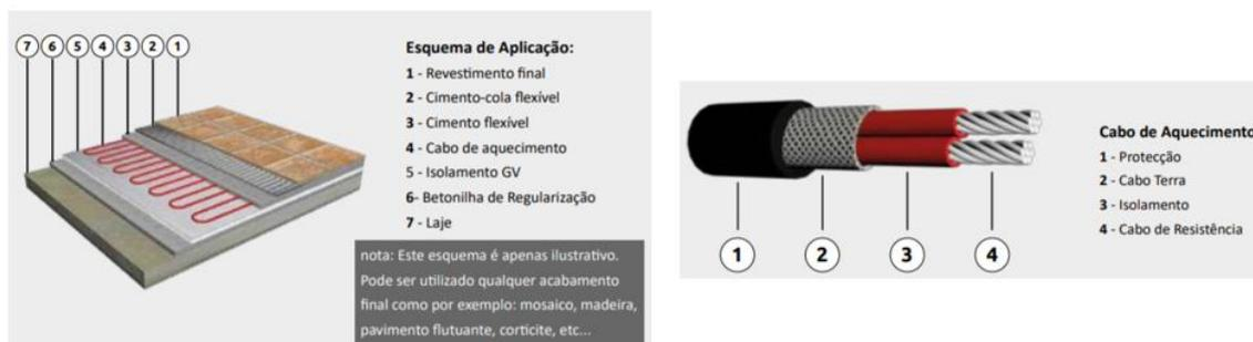
Figura 22 - Pavimento radiante elétrico, Fabricante: Globovac
