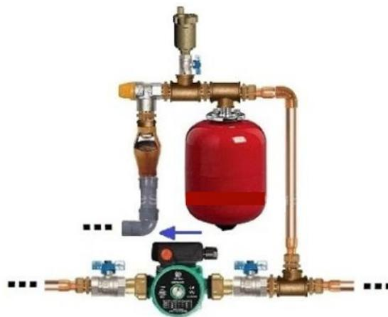
Figura 59- Esquema com vaso de expansão
