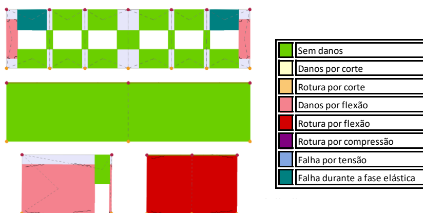
Figura 6.6: Distribuição de danos nos elementos estruturais verticais para o carregamento na direção X.
