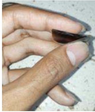
Figura 4 Biopolímero obtenido a partir de almidón de plátano. Fuente: Autores
