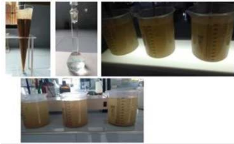
Figura 3 Preparación del coagulante a partir del mucílago de café y aspecto del agua de la quebrada La Nacuma (pre y post tratamiento). antes y después del tratamiento.
