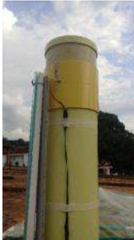
Figura 8 Tubo dispensador de Agua de los Humedales de ET Fuente: Autores
