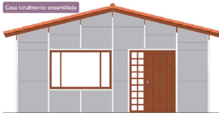
Figura 6: Casa prefabricada en concreto totalmente ensamblada.
