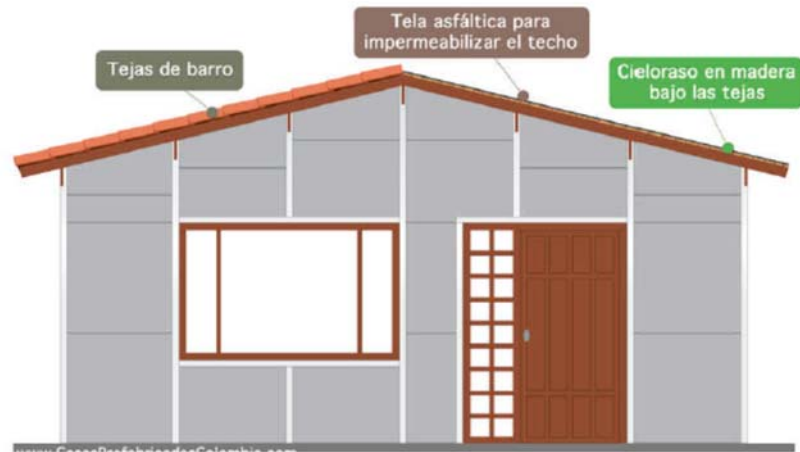
Figura 5: Instalación de cieloraso, tela asfáltica y tejas de barro.
