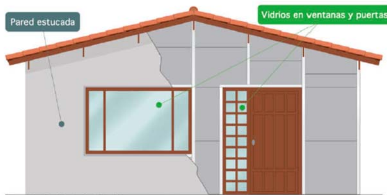
Figura 7: Proceso de estucado de paredes e instalación de vidrios en ventanas.
