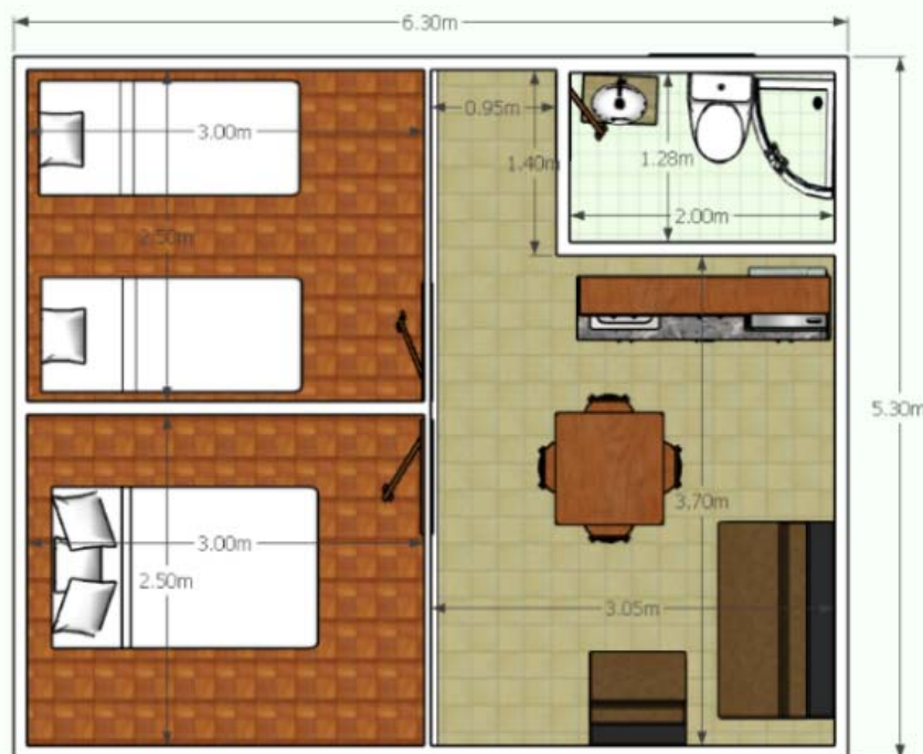
Figura 25: Vista de Planta de VUF 02: 33.39 m2.
