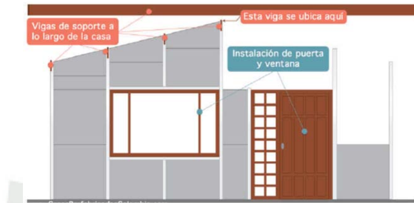
Figura 3: Ensamblaje de placas con puerta y ventanas. CADECOL
