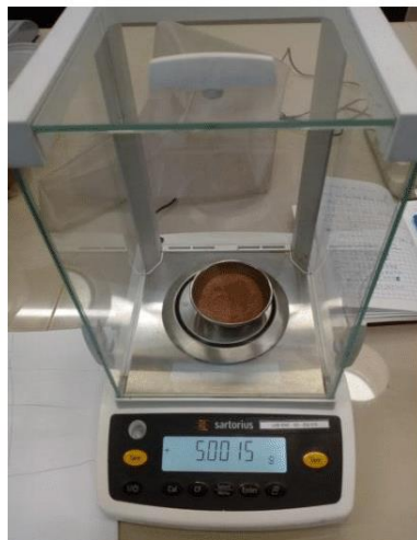
Ilustración 5 Pesaje del tamiz #40 de la especie Tornillo
