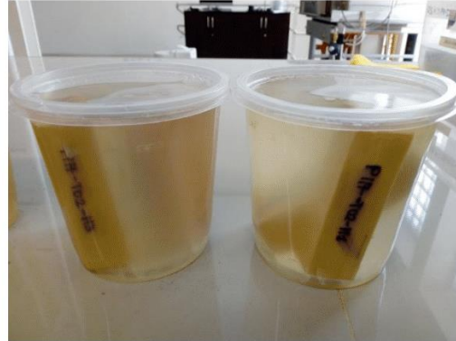
Ilustración 2: Probetas de zapote en estado de saturación
