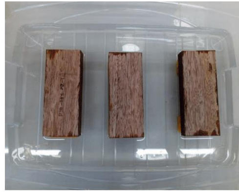
Ilustración 2: Probetas de tornillo sometidas al ensayo de absorción en agua.
