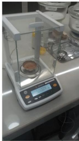
Ilustración 3 Pesaje de la muestra en la balanza de precisión
