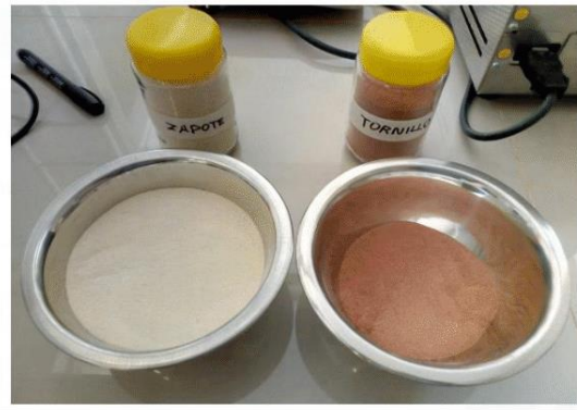
Ilustración 2 Muestra de las especias pasadas por tamiz 40
