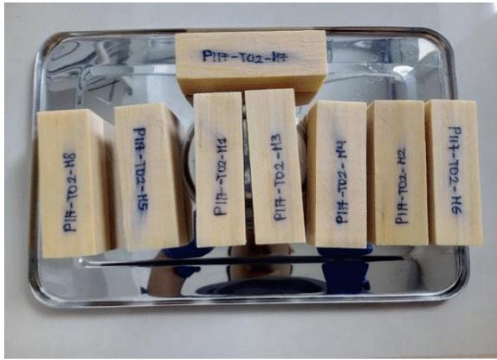
Ilustración 3: Probetas de zapote después de finalizar la saturación (1 mes)
