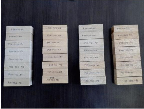
Ilustración 1: Probetas sometidas a la prueba de densidad. Ocho probetas por especie
