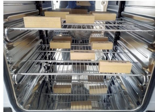
Ilustración 4: Probetas de zapote en la estufa para la obtención de la masa anhidra.
