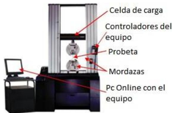
Figura 11 Esquema de Máquina para Ensayo a Tracción [27]
