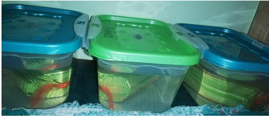
Figura 16 Probetas sumergidas en químicos abrasivos
