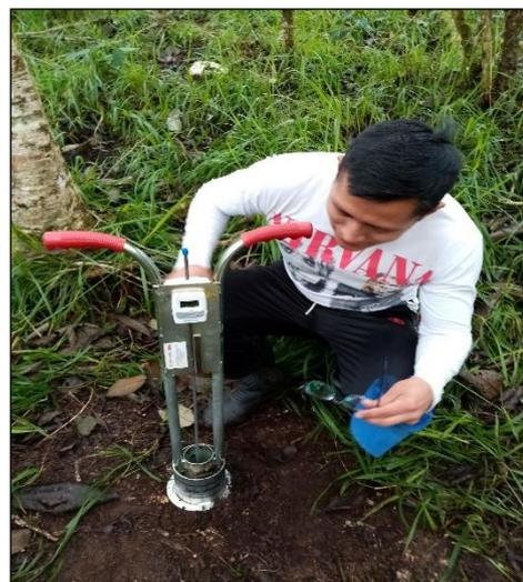
Anexo 19: Medición de infiltración con el infiltrómetro de césped – Tec.
