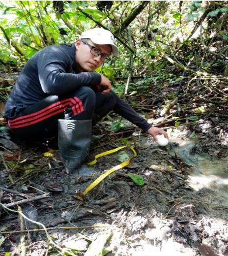
Anexo 22: Medición de caudal con el método del flotador.
