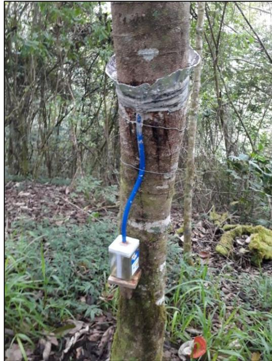
**Ilustración 3:** Colector de flujo.
