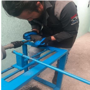
Figura 3.32 Perforación del taco de caucho
