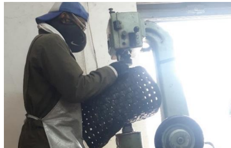
Figura 3.23 Costura del perímetro de la moqueta
