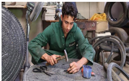
Figura 1.12 Proceso artesanal de reciclaje de neumáticos (SIGNUS, 2019)
