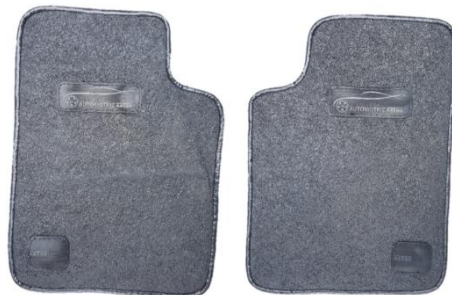
Figura 3.28 Posicionamiento de taconeras en la moqueta
