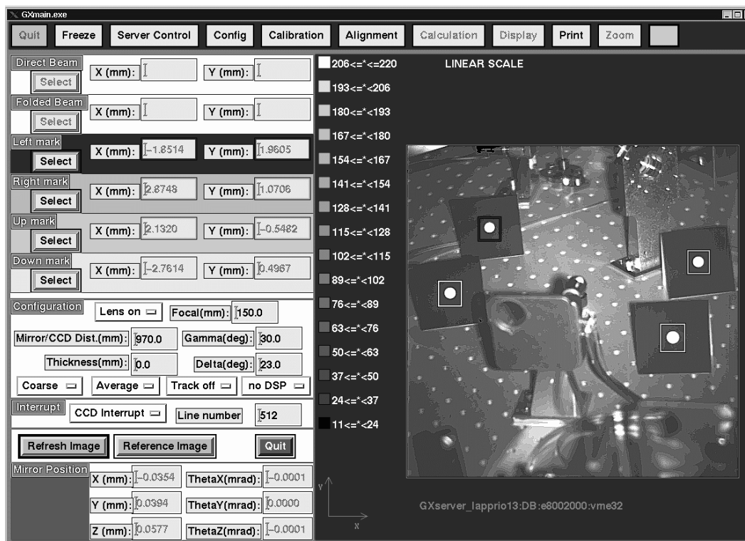
Figure 4.3: Image de l'interface utilisateur GalaXie pour l'alignement. Il est possible de distinguer les marques du banc de détection et les rectangles qui délimitent la zone utilisée pour le calcul des coordonnées des taches.
