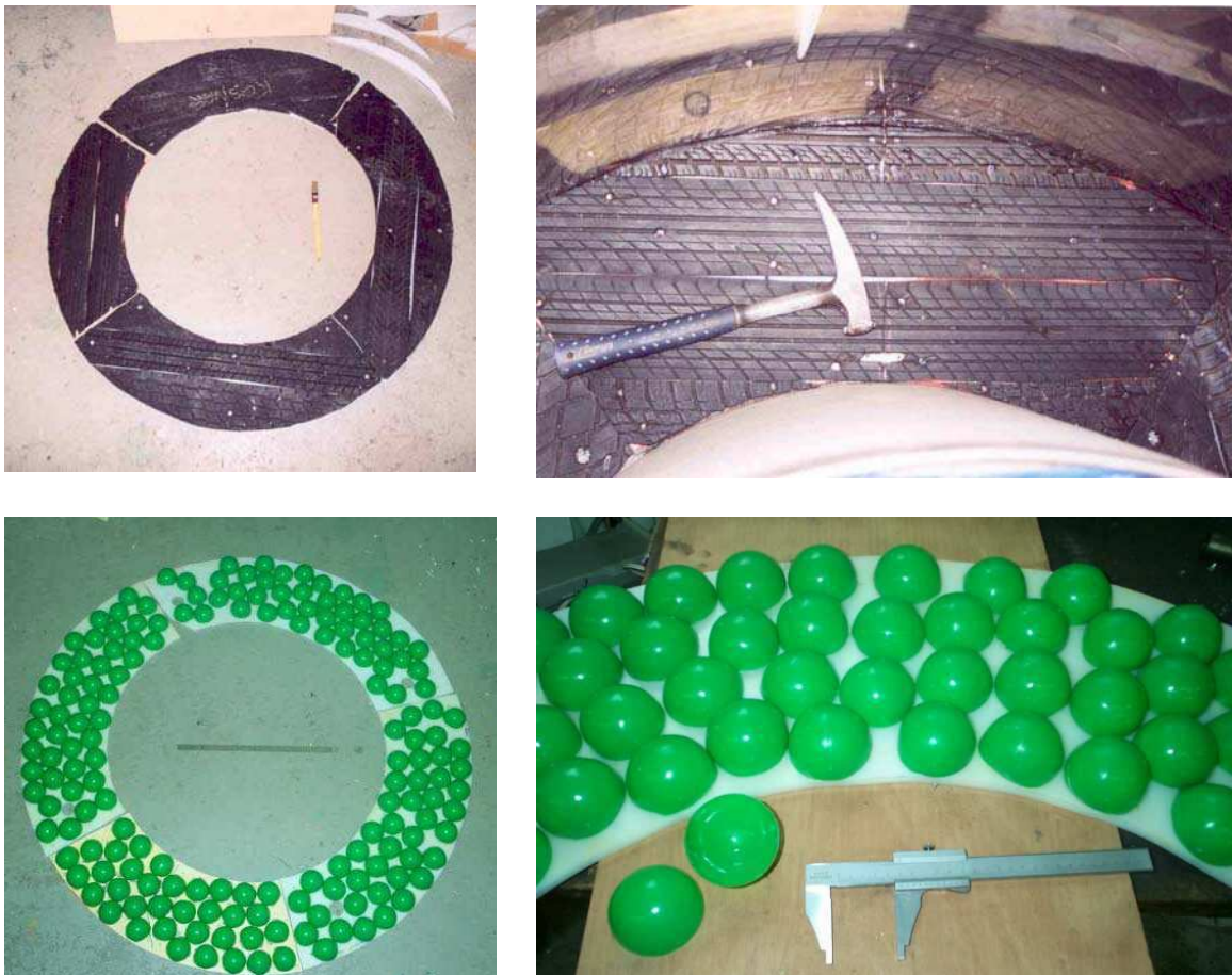
Figure 38 : les parements basaux. En haut, fond en pneu ; en bas, fond à forte rugosité. A gauche, les parements assemblés (diamètre externe = environ 1,5 m) ; à droite, détail.
