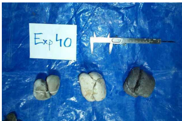
Figure 76 : les fragments récupérés à la fin de l'expérience 40 ont permis de reconstituer trois galets qui ont éclaté sous l'effet des chocs répétés. Le pied à coulisse est ouvert de 5 cm.
