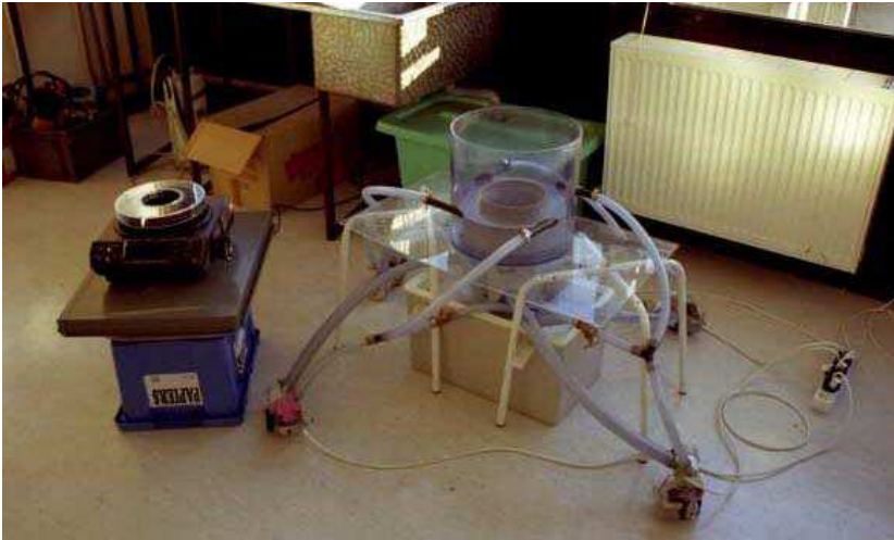
Figure 14 : vue d'ensemble du dispositif expérimental à l'échelle 1/5 ème . Sur la gauche, le projecteur à diapositives utilisé pour les expériences de visualisation du champ de vitesse des fluides.
