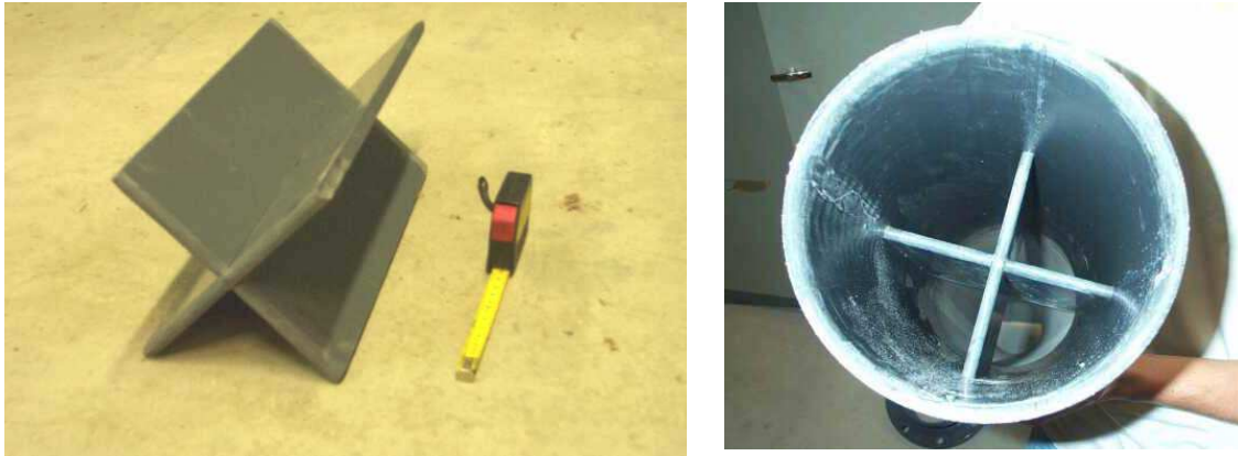
Figure 33 : le redresseur de courant qui a été placé dans la tuyauterie en sortie de pompe pour stabiliser l'écoulement. Photo de gauche : seul ; photo de droite : fixé dans le tube PVC.
