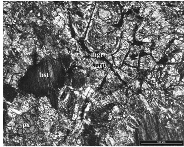
Fig. II.2-5 : Reliques des minéraux constitutifs de l'ancienne péridotite et textures de remplacement (image en LPA) : ol=olivine ; px=pyroxène ; bst=bastite ; serp=serpentine ; mgt=magnétite
