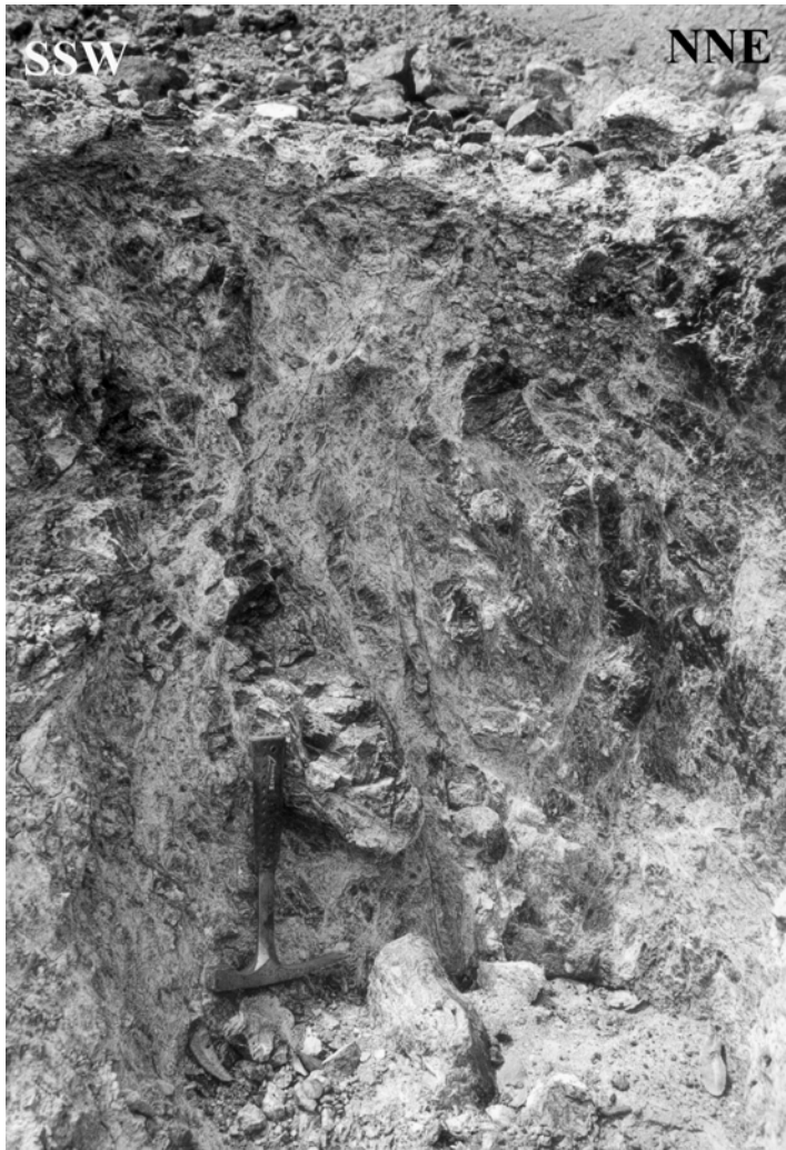
Fig. II.1-9 : Gougée de la faille de Little Pine (Santa Barbara County, Cal.). Des roches de natures variées (sédiments et serpentinites) sont mélangées au sein de cette zone broyée de moins d'un mètre de large.
