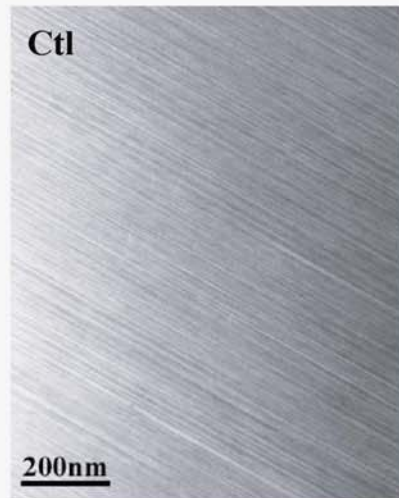
Veine fibreuse de chrysotile
