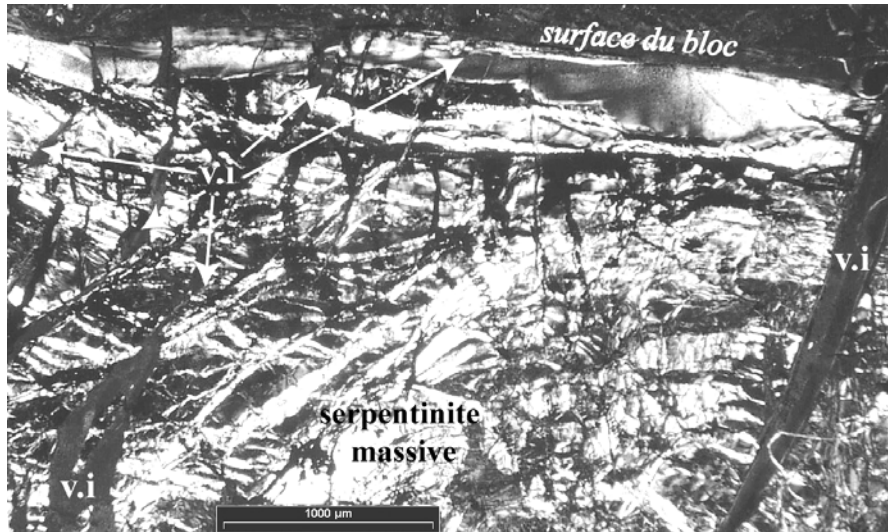
Fig. II.2-29 : géométrie caractéristique du réseau de veines isotrope (v.i) qui se développe perpendiculairement à la surface des blocs massifs de serpentinite. Ces veines peuvent aussi recouvrir la surface des blocs (cf. Fig. II.2-12).
