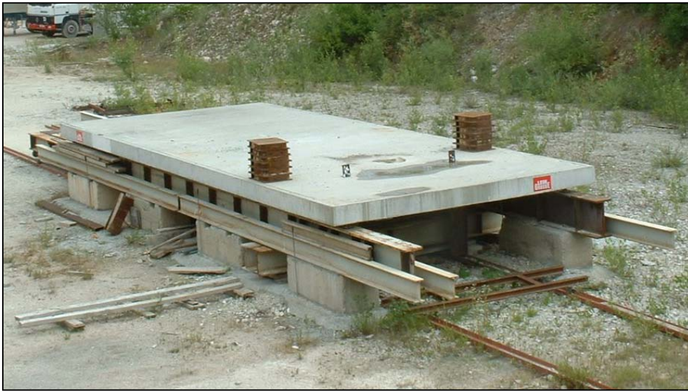
figure III.1 : vue générale de la dalle d'essai
