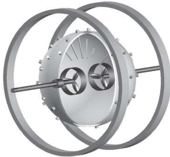
FIG. 1.9 - Schéma du dispositif expérimental de Madison avec un quart de sphère supprimé afin de voir l'intérieur où l'écoulement est généré par la rotation de deux hélices. On distingue également l'emplacement des sondes à effet Hall à la surface et dans les tubes à l'intérieur de la sphère [Spence et al., 2006].
