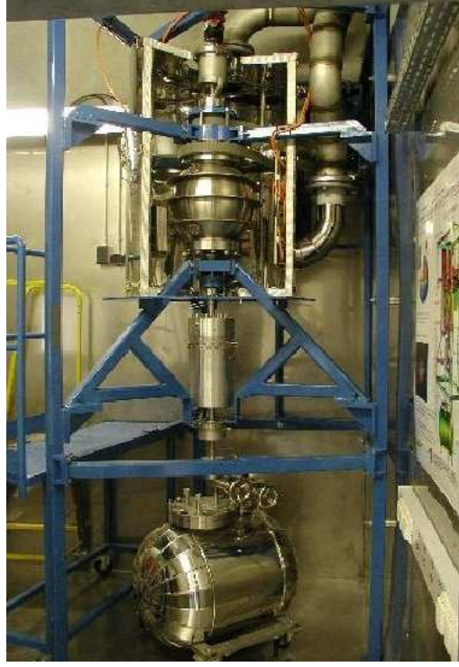
FIG. 2.1 - Photo du dispositif expérimental de DTS où on aperçoit la sphère externe et le réservoir de stockage du sodium à la base de l'installation.
