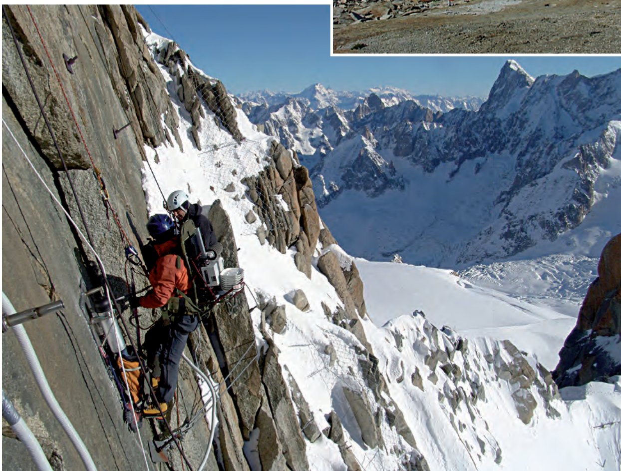
Figure 7 - Installation d'une station météorologique automatique et de capteurs de température dans la roche sur la face sud de l'Aiguille du Midi (massif du Mont Blanc, 3842 m) dans le cadre du projet Interreg PERMAdataROC.
