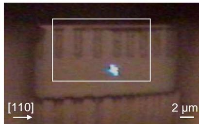
FIG. 2.9: Échantillon de type DTI préparé par FIB. Le cadre de la cartographie est matérialisé.
