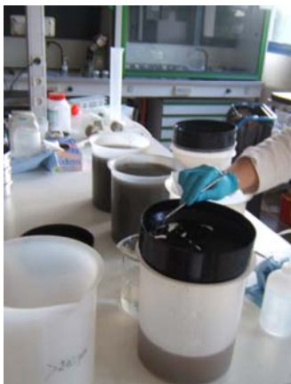
Figure II-3 : Opération de tamisage par voie humide
