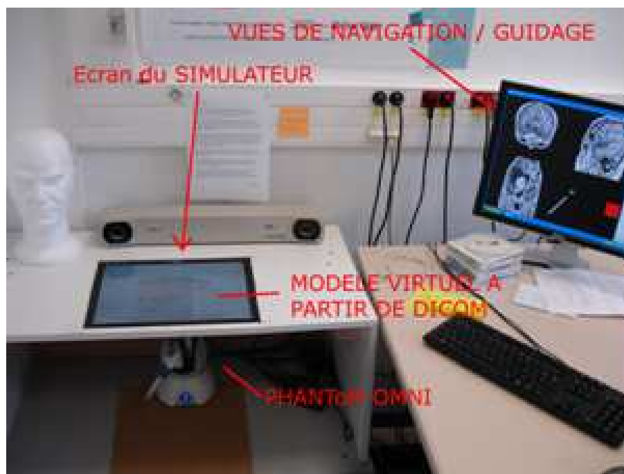
FIGURE 8.11 – Prototype de simulateur chirurgical en base du crâne développé. Le retour d’effort est assuré par le dispositif haptique (Phantom Omni), situé sous l’écran de visualisation placé horizontalement. Une localisation de la position du dispositif haptique dans les données anatomique est possible sur un écran déporté.
