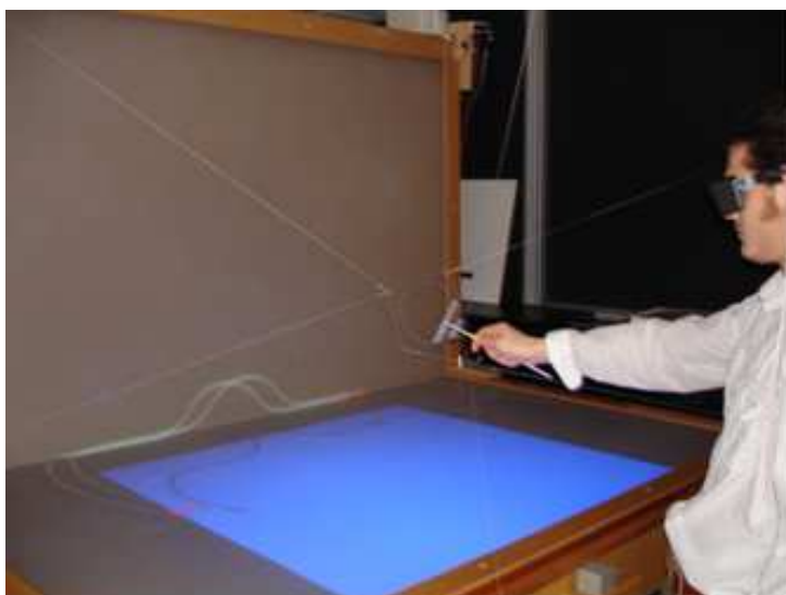
FIGURE 7.12 – Sujet en cours de réalisation de l'expérience. Le sujet tient à la main la baguette (objet manipulable du dispositif haptique) qu'il doit déplacer le long du fil (représenté en jaune). Deux boules rouges indiquent le début et la fin de la trajectoire.
