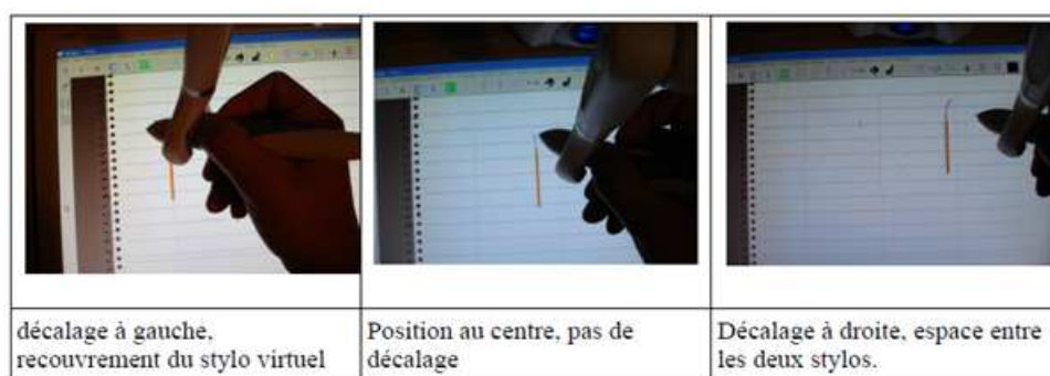
FIGURE 6.5 – Point de vue de l'utilisateur. (Gauche et droite) Exemples d'erreurs de calibrations impliquant une transformation mentale des espaces à la production d'un geste. (Centre) Calibration correcte permettant la réalisation d'un geste sans surcharge mentale.
