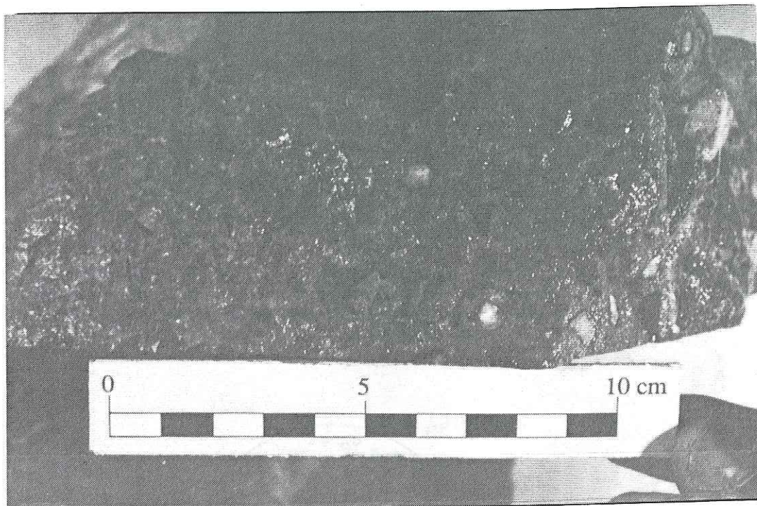
Fig. B.III.15 : agglomérat de "balles" de sidérite (diamètre:environ 1 cm) formées de cristaux ayant poussé concentriquement autour d'un germe plurimillimétrique constitué de fragments de schistes et/ou de quartz. le dépôt de la sidérite s'est effectué à cet endroit (chantier 72W) sous la forme de ces balles, qui ont été cimentée, sitôt leur dépôt effectué, par de la sidérite venant cristalliser entre les balles. Des vides subsistent entre les balles.
