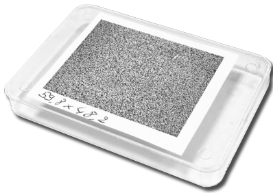
Figure 4.5 – Image de la mire plane utilisée lors de l’opération de calibrage du système de stéréovision. Cette mire représente un mouchetis aléatoire.
