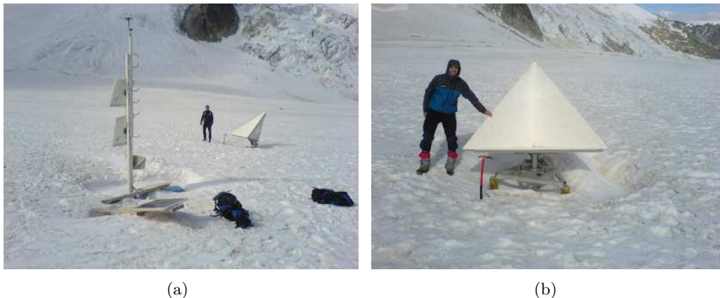
FIGURE 1.20 – Réseau d’observation mis en place sur le glacier d’Argentière dans le cadre des projets MEGATOR et EFIDIR : (a) station GPS-1, Coïn Réflecteur du DLR (CR-D1) et Coïn Réflecteur EFIDIR (CR-A1), placé sur la partie haute du glacier et (b) focus sur le Coïn Réflecteur du DLR (CR-D1).
