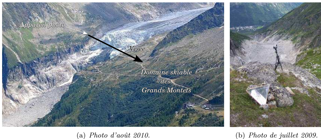
FIGURE 1.16 – Appareil photo numérique automatique HR positionné en rive droite du glacier d'Argentière au niveau de la chute de séracs de Lognan. (a) Position par rapport au glacier et (b) photo de l'appareil photo accompagné du Coin Réflecteur EFIDIR CR-D4.
