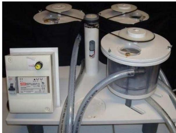
**Figure 18 : Un banc de réacteurs biologiques**
