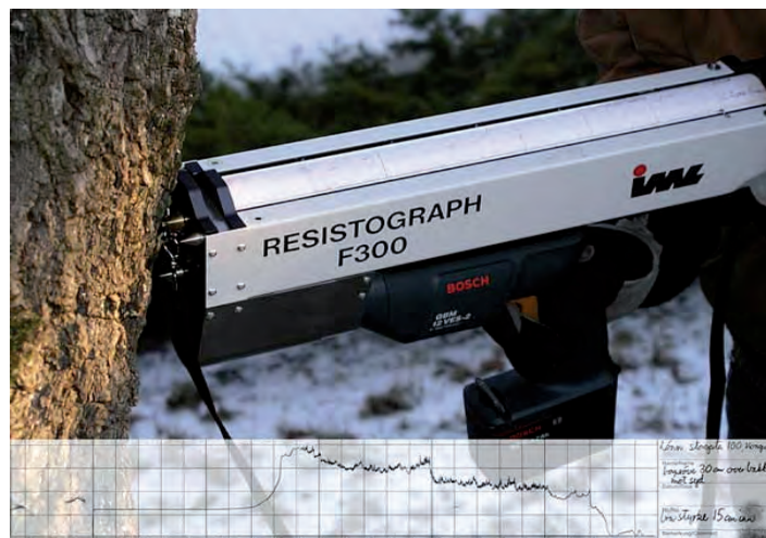
Figure 3 - Unité de forage du résistographe "IML Resi F400".
