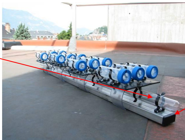
Figure 32 : Dispositif de fixation d'une lampe UV et des supports artificiels pour l'étude de la croissance des biofilms dans les tours aéro-réfrigérantes.
