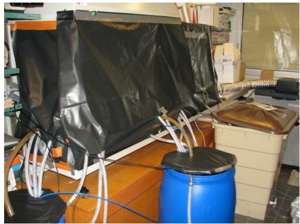
Figure 31. Disposition des bancs de réacteurs biologiques (un banc "témoin" et deux bancs "essai", pour chacune des expériences).
