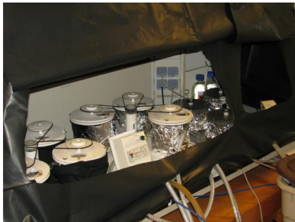
Figure 31. Disposition des bancs de réacteurs biologiques (un banc "témoin" et deux bancs "essai", pour chacune des expériences).
