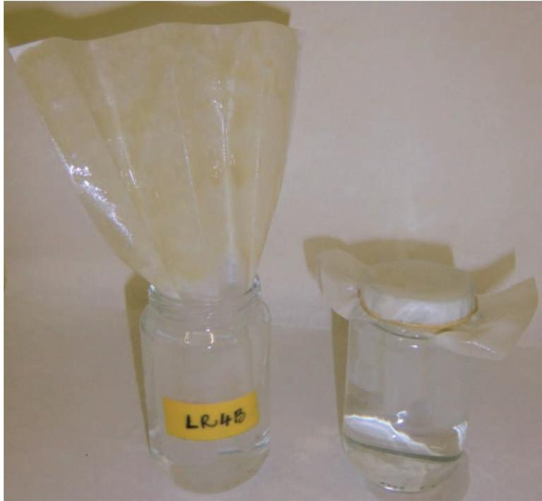
**Figure 3.** Pot en verre avec papiers à miel en accordéon (gauche) ou recouvrant (droite).
