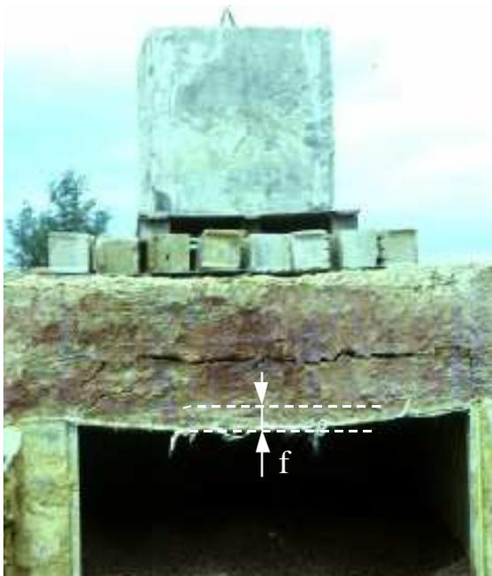
Figure 5. Test de flexion sur une couverture minérale argileuse renforcée (Cered).
