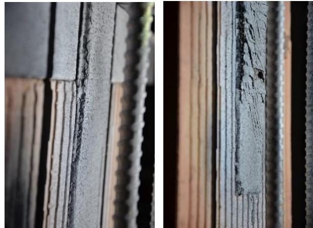
Figure 9. Illustration de la propagation du délaminage le long du corps d'éprouve « acier-2-ii », représentatif de l'ensemble des TRC acier testés.
