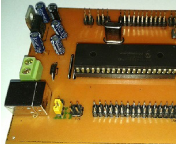
Fig. 4. Placa de desarrollo con Bootloader HID utilizando el microcontrolador PIC18F4550 con puerto USB integrado.
