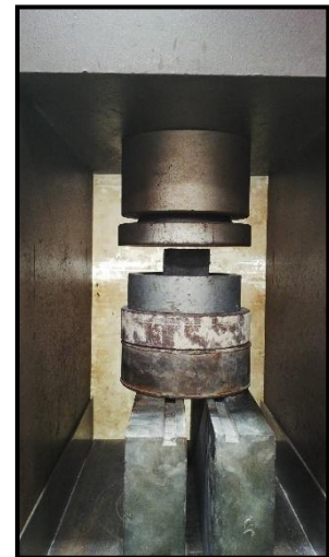
Foto 9, 10 y 11. Prueba de Compresión. Proceso realizado en el taller de Ingeniería Civil y Arquitectura. ITCA – FEPADE; Sede Central
