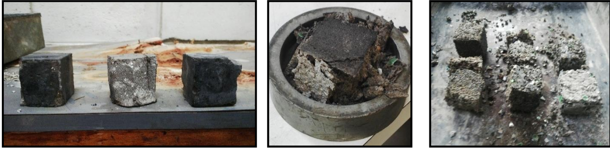
Foto 12, 13 y 14. Resultado de la Prueba de Compresión. Proceso realizado en el taller de Ingeniería Civil y Arquitectura. ITCA – FEPADE; Sede Central
