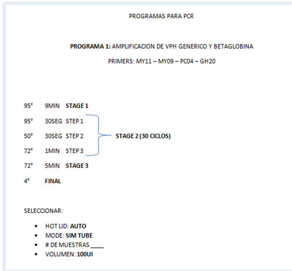
Fig. 1 Ilustración del protocolo a seguir para la programación del termociclador para la realización de una PCR genérica.
