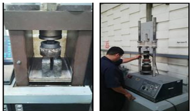
Fotografía 9 y 10. Prueba de compresión.
