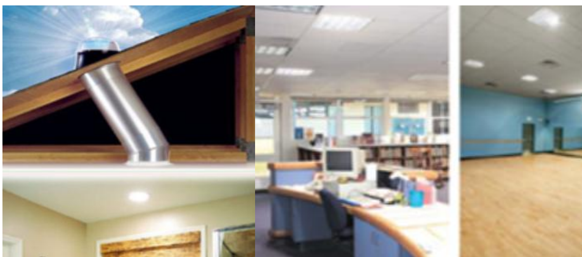
Imagen 6. Sistema de Captación Iluminación por medio de Solatube.
