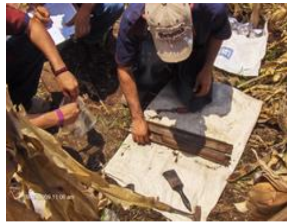
Trabajo de campo. Estudiantes y docentes realizan perforaciones de suelo y recolectan muestras para estudio
