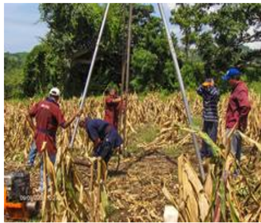
Trabajo de campo. Estudiantes y docentes realizan perforaciones de suelo y recolectan muestras para estudio
