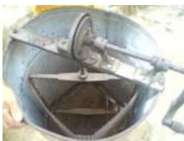
Imagen 7. Máquina centrífuga, para la extracción de miel de abaje con aguijón.
