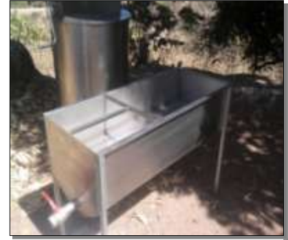
Fig.6 Mesa desaperculadora de acero inoxidable de APICABAÑAS.
